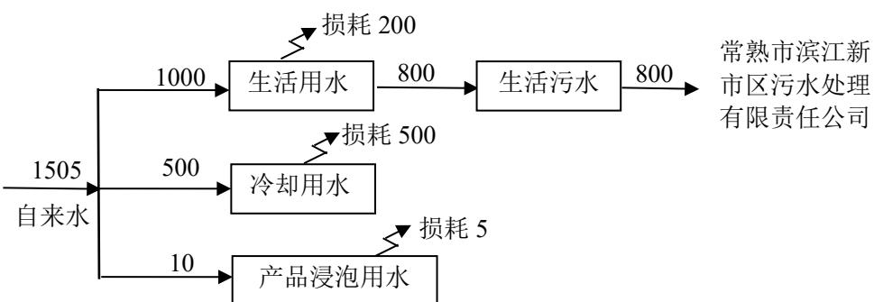
图 2-2 通达路 19 号扩建项目给排水平衡图 (单位 t/a)
