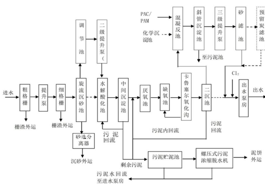
图 4-1 污水处理厂废水处理工艺流程图
