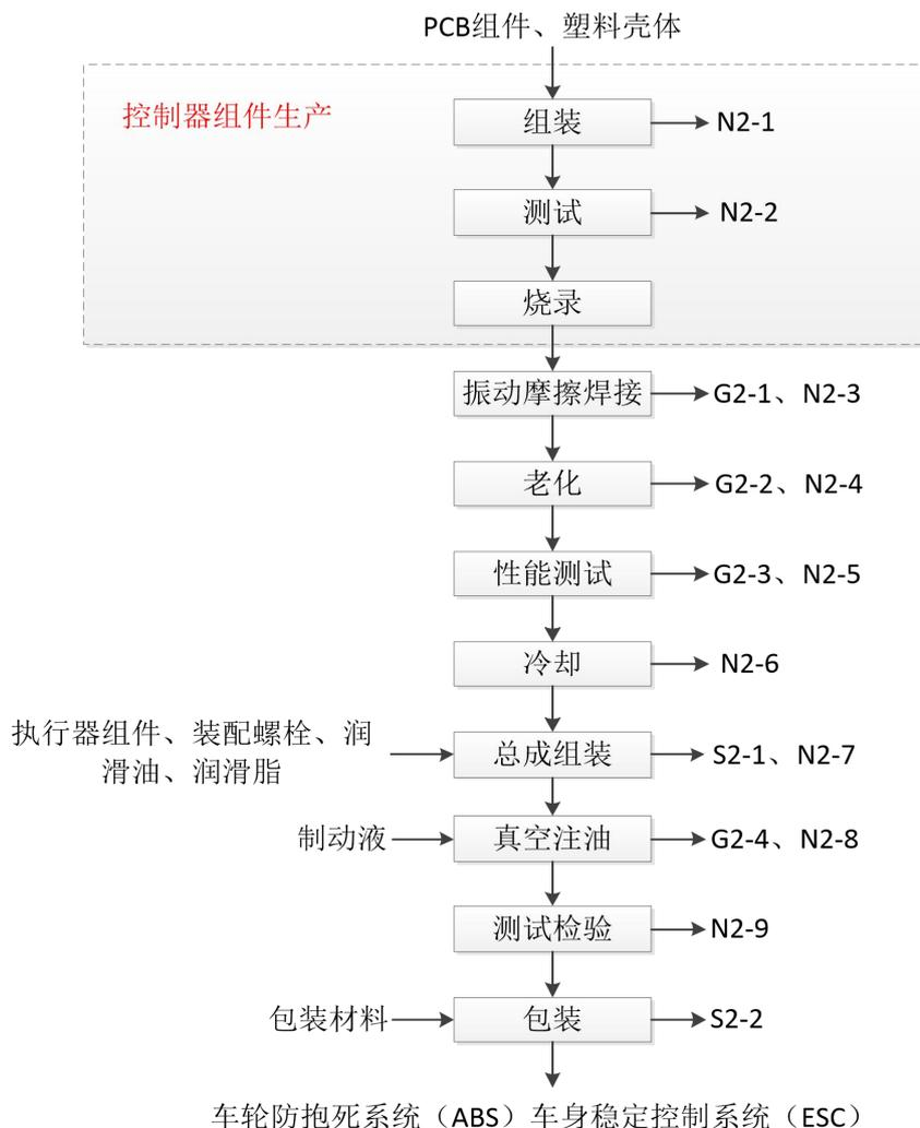
图 2.10-2 本项目车轮防抱死系统（ABS）、车身稳定控制系统（ESC）生产工艺及产污节点
