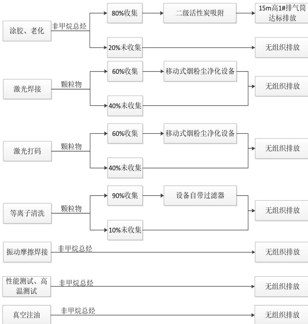
图 4.1-1 本项目生产废气收集、处理及排放方式图
